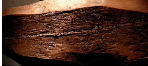
Figure 11. Rayure longitudinale d'un pieu de chêne de la Plage Saint-Michel consécutive à son enfoncement (cliché V. Bernard).
