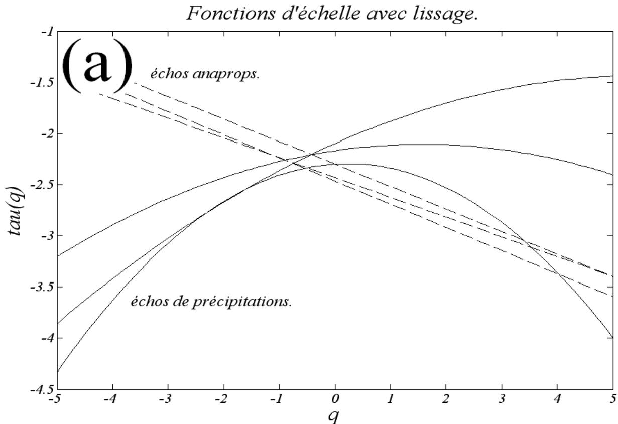
**Figure 7 : (a) :** Fonctions d'échelles d'anaprops et des échos de précipitations avec interpolation et des valeurs de  $-5 < q < +5$  pour les moments statistiques. **(b) :** Spectres de Legendre obtenus avec l'analyse multifractale par la méthode MMTO-2D de 3 images d'anaprops et 3 images d'échos de précipitation.
