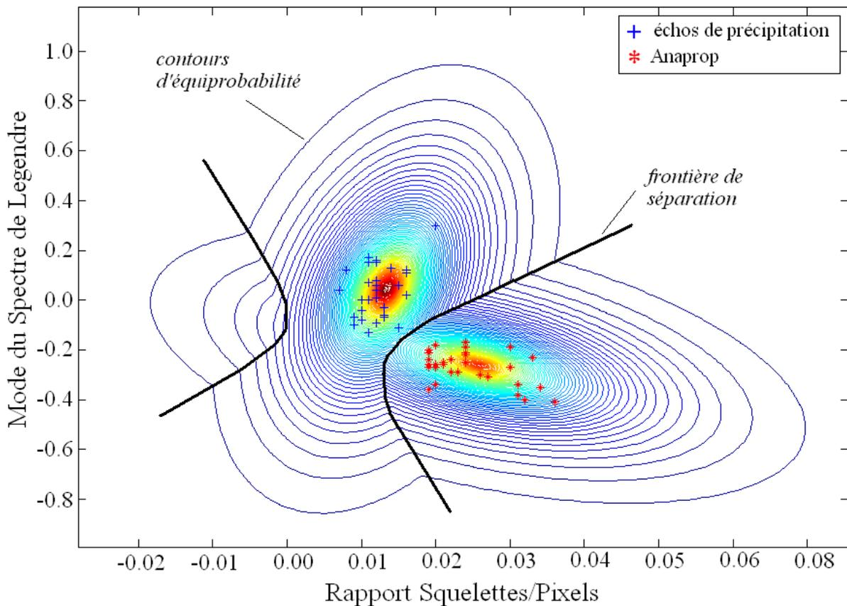
**Figure 8 :** Classification des échos de précipitations et d'anaprops (30 images d'anaprops et 30 images d'échos de précipitations) avec deux paramètres : l'exposant de Hölder du mode du spectre de Legendre, et le nombre de squelettes par pixels d'échos radar. Contours d'équiprobabilité en code couleurs, et en noir l'hyperbole qui représente la frontière de séparation entre les deux classes.
